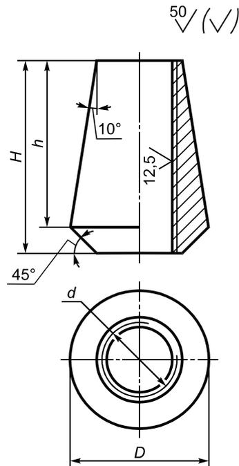
Рисунок 15 — Коническая втулка (поз. 16 на рисунке 1)
