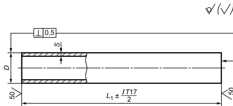
Рисунок 7 — Труба (поз. 1 на рисунке 6)
