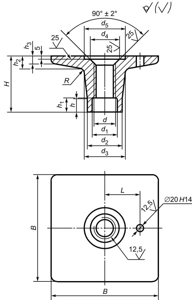
Рисунок 9 — Анкерная литая плита (поз. 3 на рисунке 6)
